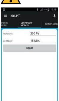
Im Feld PRÜFDRUCK kann der Prüfdruck in den Grenzen 50 bis 500 Pa eingestellt werden (die Druckvorgabe beim Aufruf dieses Modus ist 250 Pa).
