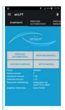
Es werden die Gerätedaten wie Firma, Name des Geräts, Hardware-Version, Software-Version sowie der Status des Selbsttestes ausgelesen und angezeigt.
