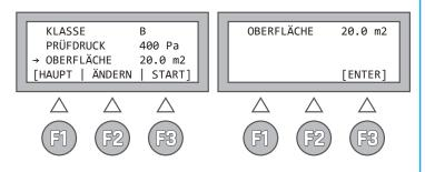
Nach Druck auf die **START-Taste (F3)** beginnt die Prüfung. Der aktuelle Druck in Pa und der Volumenstrom in I/s (mit zwei Nachkommastellen) werden ständig angezeigt. Die Automatik regelt den Druck auf den vorgegebenen Prüfdruck ein. Sobald dieser auf +/-
