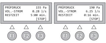
Mittels der Taste **STOP (F3)** kann die automatische Prüfung vorzeitig beendet werden. Es erfolgt dann eine Auswertung über die bis zu diesem Zeitpunkt abgelaufene Messdauer. Jedoch wird keine Aussage darüber gemacht, ob die Prüfung bestanden wurde, da diese nicht normkonform über eine Zeitdauer von 5 min durchgeführt wurde (siehe EN 1507:2006 Abschnitt 5.22).
