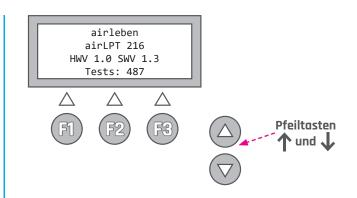
Nach drei Sekunden signalisiert das Gerät auf dem Display **(5)**, dass interne Tests (Geräteselbsttest) durchgeführt werden.
