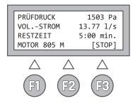
Der aktuelle Druck in Pa und der Volumenstrom in I/s (mit zwei Nachkommastellen) werden ständig angezeigt. Außerdem erscheint im Display **(5)** ein Zahlenwert zwischen O (Drehzahl = 0) und 4095 (Drehzahl maximal) zur Orientierung, mit welcher Drehzahl der Ventilator läuft. Immer, wenn der Prüfdruck sich im Toleranzfenster befindet, zählt ein Countdown-Zähler von 5 Minuten bis O.
