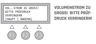
Sollte das Leckvolumen beim eingestellten Prüfdruck unter der unteren Messgrenze von 0,08 l/s liegen, so läuft die Messung weiter, es kann aber kein konkreter Messwert ermittelt werden. Als Ergebnis wird dann "Leckvolumen < 0,08 l/s" ausgegeben.
