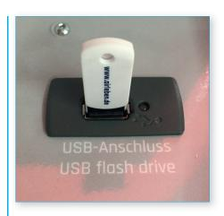
Tritt hier ein Fehler auf, so erfolgt für 3 s ein Warnhinweis auf dem Display **(5)**. Dieser Fehler ist KEIN schwerwiegender Fehler, sodass das Gerät weiterhin betrieben werden kann, allerdings ohne die Möglichkeit, Daten auf dem USB-Stick zu lesen und zu speichern.
