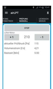
Mittels des Stop-Buttons kann die manuelle Prüfung vorzeitig beendet werden.
