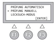
Nach Betätigung der Starttaste **(F3)** läuft der Ventilator nicht automatisch an, sondern er muss mittels der Pfeiltasten ↑ und ↓ auf eine Drehzahl einreguliert werden, bei der der voreingestellte Prüfdruck in den Grenzen +/- 5 % eingehalten wird. Werden die Pfeiltasten länger als 1,5 s festgehalten, so erfolgt eine schnelle Veränderung der Ventilator-Drehzahl.
