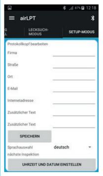
Gerätedaten Πie werden ausgelesen und in der App dargestellt. Die Daten des Protokollkopfes dargestellt werden und können geändert werden. Nach dem Betätigen des Buttons Speichern werden die Daten an das Prüfgerät übermittelt.
