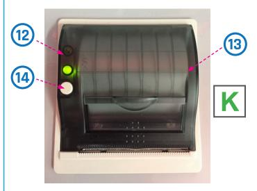
Mit der Taste (14) an der linken Seite des Druckers ist ein manueller Papiervorschub möglich.
