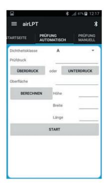
Im Feld Oberfläche kann die Oberfläche zwischen 0,1 und 2.000 m² eingestellt werden.
