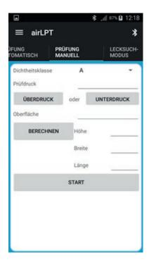
Dieser entspricht dem automatischen Prüfmodus mit der Ausnahme, dass der Prüfdruck durch Änderung der Ventilator-Drehzahl manuell auf den eingegebenen Sollwert eingeregelt werden muss.
