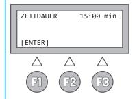
Nach Druck auf die **START-Taste (F3)** beginnt der Lecksuch-Modus, Ständig wird der aktuelle Druck in Pa und die
